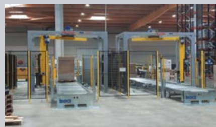
Exemple de ligne palette avec filmage automatique
